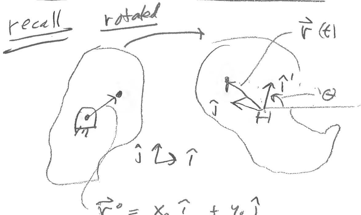
$$\begin{bmatrix} x \\ y \end{bmatrix} = \begin{bmatrix} \cos\theta & -\sin\theta \\ \sin\theta & \cos\theta \end{bmatrix} \begin{bmatrix} x_0 \\ y_0 \end{bmatrix}$$
