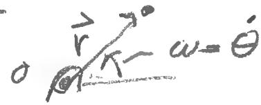
$$\vec{a} = \vec{\alpha} = \vec{\omega} \times \vec{r} + \vec{\omega} \times (\vec{\omega} \times \vec{r})$$
